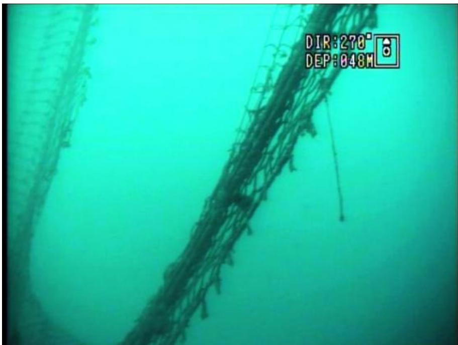
写真3 ROVで確認した定置網の破れ
