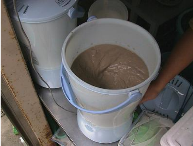
写真3 攪拌機による付着性の除去
