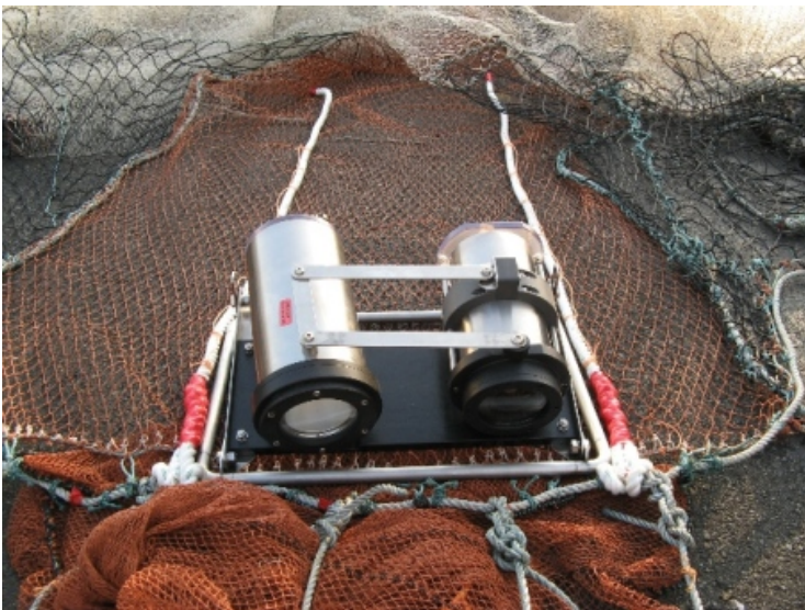
写真2 網に取り付けた水中ビデオカメラ装置
