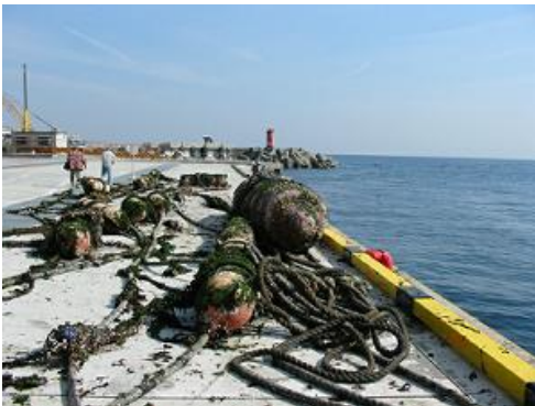
汚れて交換前のロープ
