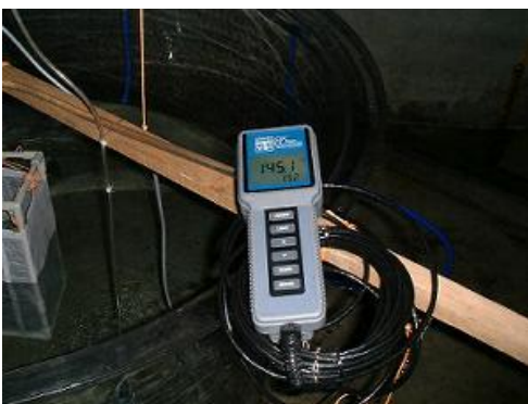
溶存酸素計（DOメーター）、酸素濃度を測ります。
