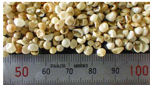
樹脂系被覆肥料被膜殻と推定される漂着した中空球状MP
