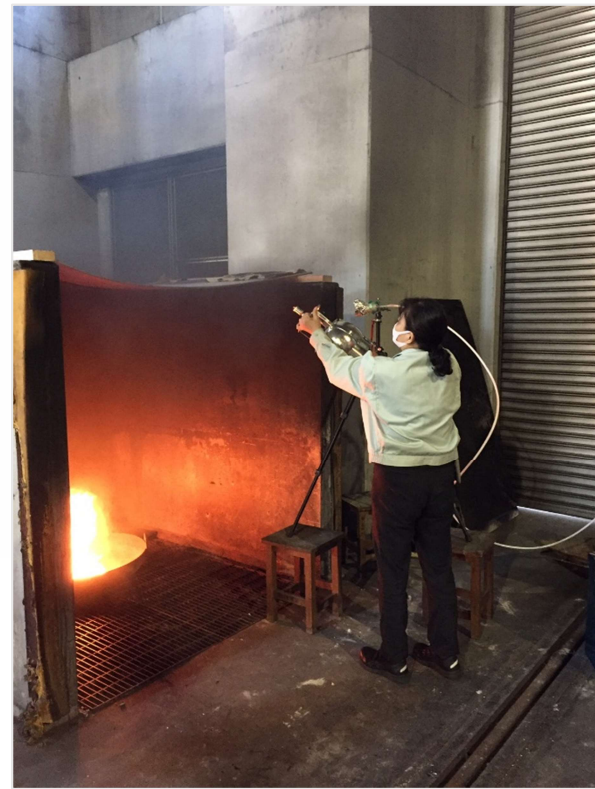
燃焼ガスをキャニスターとサンプリングバッグで捕集
