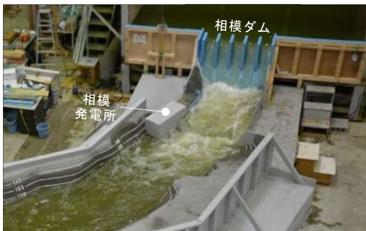
参一写真7 水理模型実験の様子
