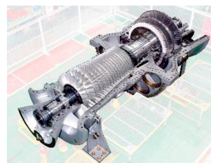
(水素対応可能なガスタービン) 出典：三菱重工業㈱ホームページ
