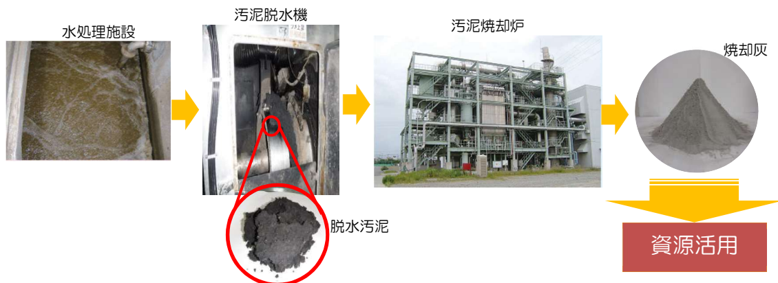
図 14 汚泥処理の流れ
