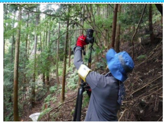
森林生態系効果把握調査の開空度測定の様相 (清川村内ヒノキ林)
