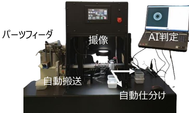
ベアリングを対象としたAI外観検査システム
