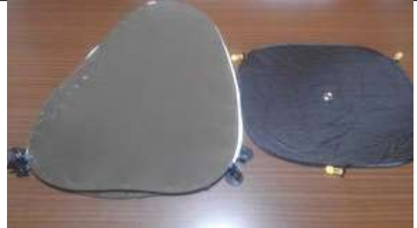
柔軟な金属枠と伸縮性のある布で構成された遮蔽壁2枚と、台座1枚。
