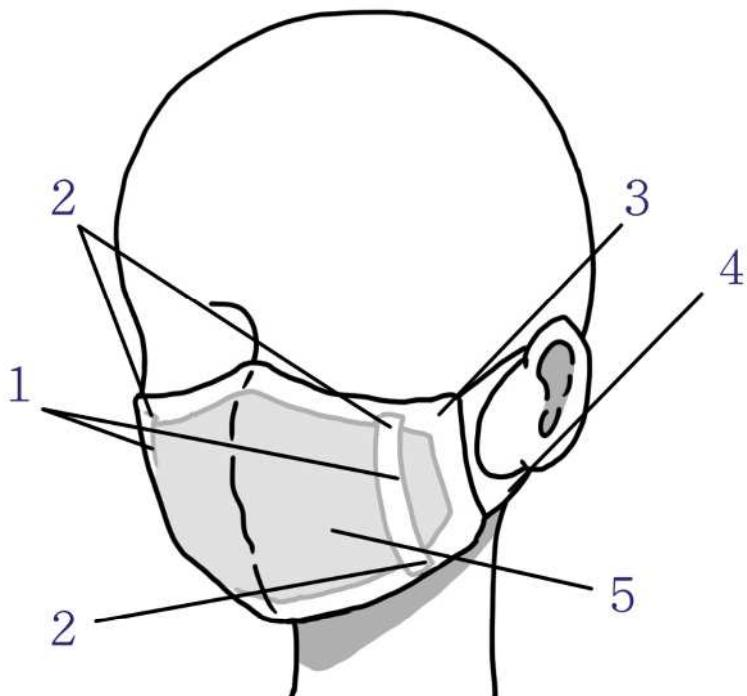
凡例 ①フィルター取付帯(ベルト)。②帯取付部。③マスク本体。④耳掛け紐。⑤任意のフィルター等(図ではマスクの内側を透過させています。)
