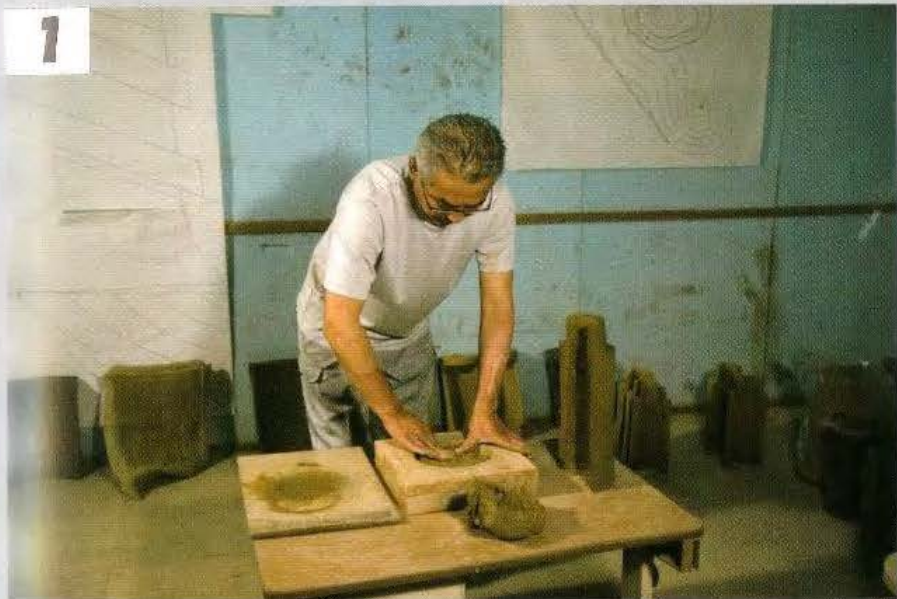
1 范に枷型（木枠）を嵌め込み、粘土を押し込む。 あらかじめ近くに丸瓦を用意しておく。
