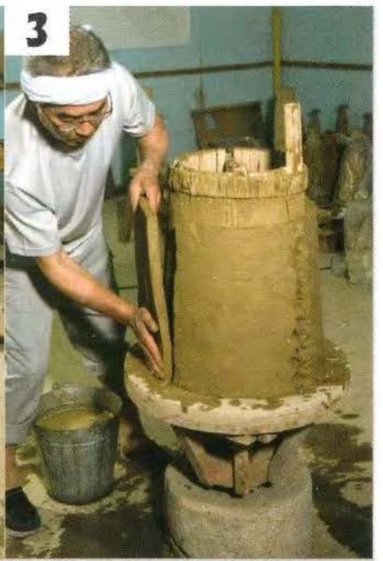
3 写真では1人で作業しているが、飛鳥時代などの大型の平瓦製作時には2人で粘土板を巻いていた可能性がある。
