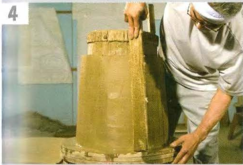
1 枠板が一段低い部分（写真手前）に分割の目安となる紐がついている。
