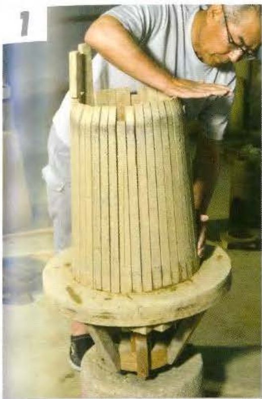
1 枠板が一段低い部分（写真手前）に分割の目安となる紐がついている。
