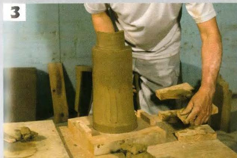
3 左右の木枠を外し接合部が離れないように、ナデ板で丁寧に整える。
