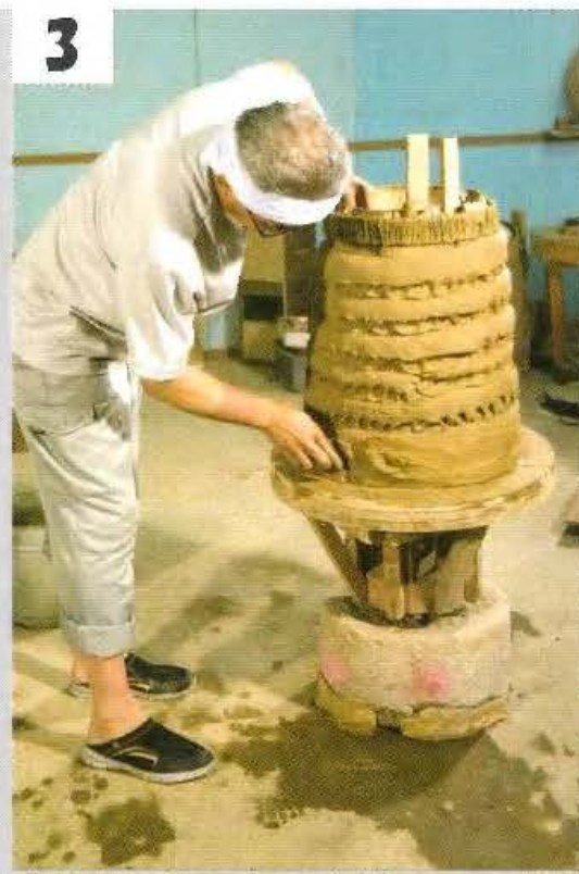
3 写真では1人で作業しているが、飛鳥時代などの大型の平瓦製作時には2人で粘土板を巻いていた可能性がある。
