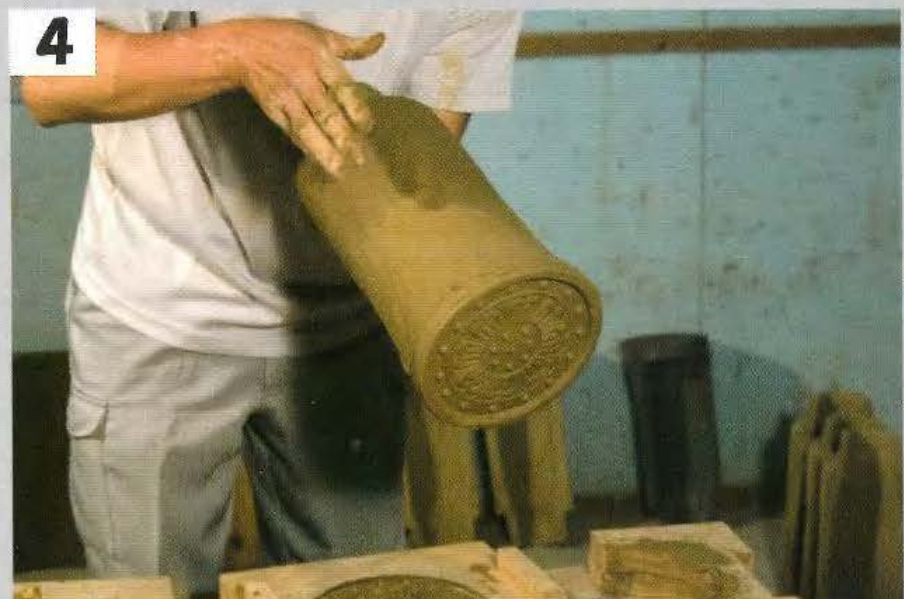
4 形が崩れないように、范からはずして整える。
