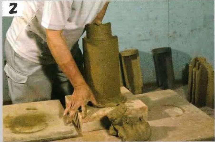
2 半乾きの丸瓦を粘土詰めした上部に押し当てて接合させる。 この時、焼成後の丸瓦の剥離を防ぐため裏面に補足粘土を加えることがある。
