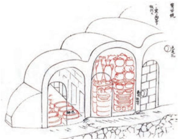
図6 サヤ（匣鉢）と棚板による窯詰め
