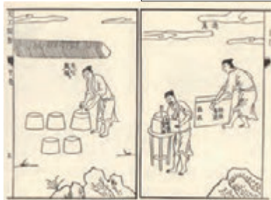
図9 『天工開物』(明末)に見る瓦作り
