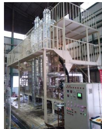
メタネーション装置の例 出典：東京ガスプレスリリース
