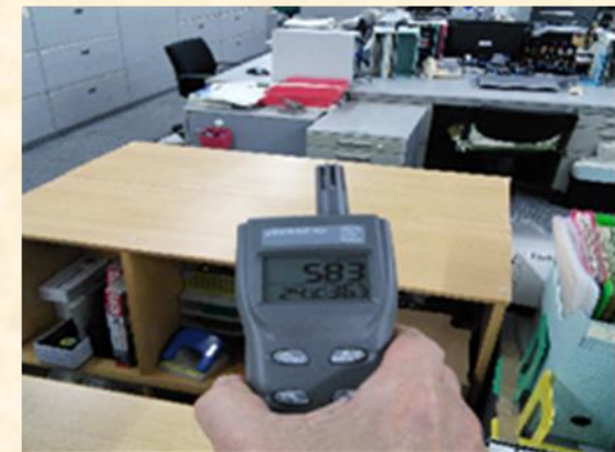
<室内環境の測定 (CO 2 計など)>
