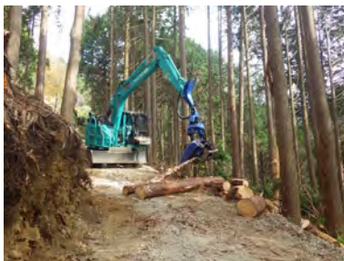
高性能林業機械を利用した 枝払い・玉切り作業の様子
