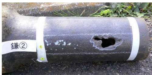
(水道管(1935年布設)の腐食状況)
