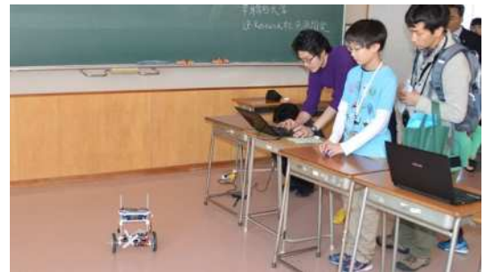
早稲田大学 ヒューマノイド研究所 橋本研究室の2輪バランスロボットは、地上だけでなく空中でも姿勢を保つ制御がなされ、倒れることはありません。
