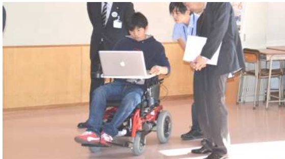
東海大学の「東海大学のロボット研究」です。「視線駆動型電動車いす」のデモ。手を使わず視線を動かすだけで車いすを操縦します。
