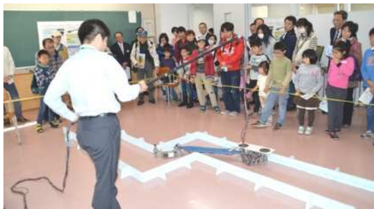
青山学院大学 山口研究室の「2台の車両型移動ロボットから構成される協調搬送システムの制御」です。長い荷台の前後に取り付けた2台の車両型ロボットが細い通路を通り抜ける動作の実演です。
