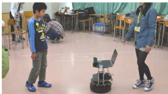
関東学院大学 理工学部 元木研究所の「機械学習のためのキッズサイズ人型ロボット」です。モーションキャプチャデバイス（画像認識）を利用した追従ロボットです。
