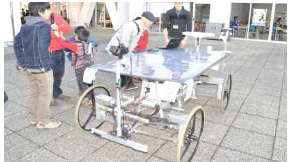
明治大学 理工学部 機械工学科ロボット工学 黒田研究室の「無人放射能観測ロボット CERES」です。高度自律移動制御技術が搭載されていて自律で移動しながら観測します。
