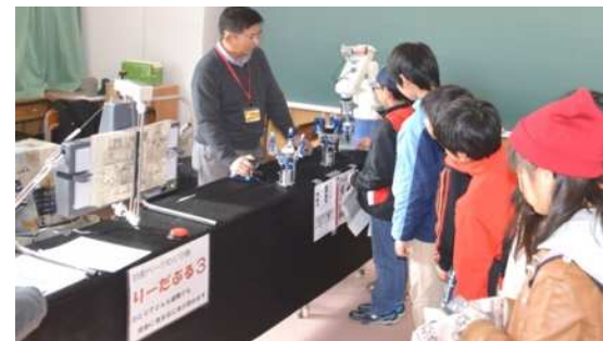
ダブル技研株式会社 の「ページめくりロボット「リーだぶる3」+ロボットハンド「D-Hand」」です。「D-Hand」は工業用ロボットで力の加減でシュークリームもつかめます。
