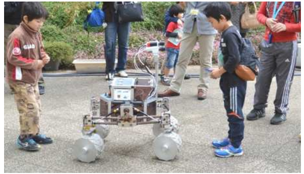
慶應義塾大学 理工学部 機械工学科 石上研究室の「不整地移動ロボット Cuatro」です。環境認識センサ付車輪型移動ロボットです。
