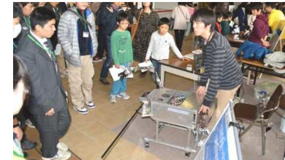
中央大学 理工学部電気電子情報通信工学科 國井研究室 の「地質試料採取用ロボットアーム」です。宇宙探査ローバの胴体部分です。鉤物などをつまんで画像など3次元情報を採取します。
