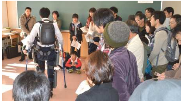
株式会社安川電機 の「歩行アシスト装置 ReWalk」です。電動制御の脚によって膝と股関節の動きを補助し、脊髄損傷等で完全に麻痺していても歩行が可能になります。
