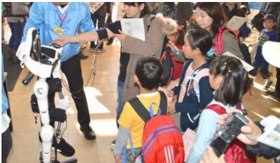
CYBERDYNE 株式会社・湘南口ボケアセンター株式会社 の「ロボットスーツHALのデモンストレーション」です。足を動かしたいと思った神経の動き(筋電)でHALの足が動きます。
