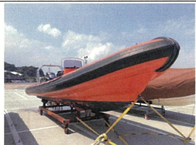
HUMBER RIBS 社製 ラバーボート 長さ：8.5m 幅：2.8m 定員：12名
