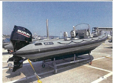
XS-Ribus 社製 ラバーボート 長さ：7.5m 幅：2.9m 定員：12名
