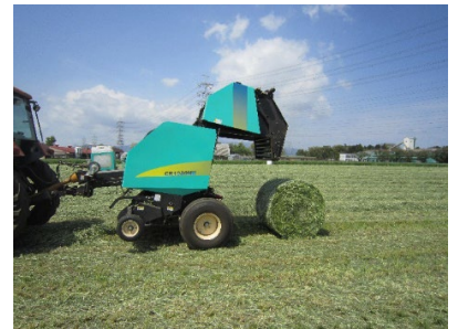
予乾した牧草はロールペーラでロールベールに成型します
