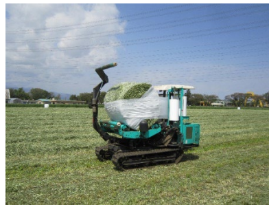
ロールベールはラップマシーンで直ちに密封します
