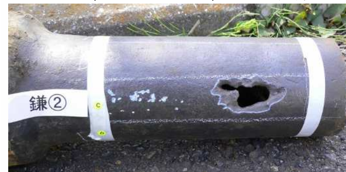
配水管 (1935年布設) の腐食状況
