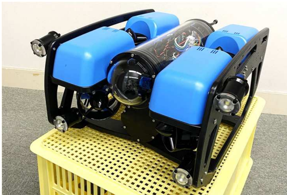
図2 水中ドローン BlueROV2 (米国 BlueRobotics 社製)
