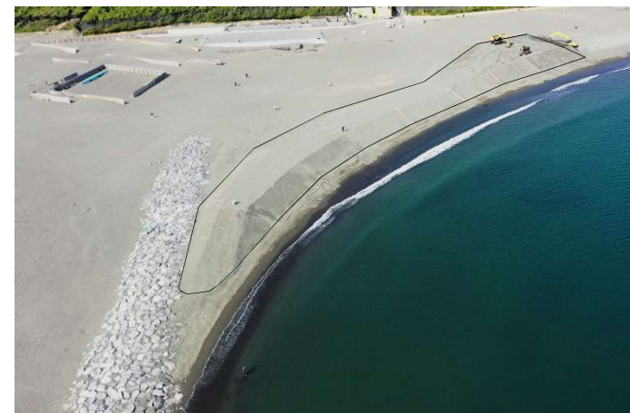
図2.7 ヘッドランド近傍のマウンド形状の養浜
