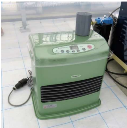
図1-2-1 燃烧式CO 2 発生機 1台で150坪まで使用可能。
