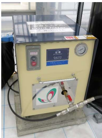
図1-3-1 細霧発生装置 粒径は10～30 μm。
