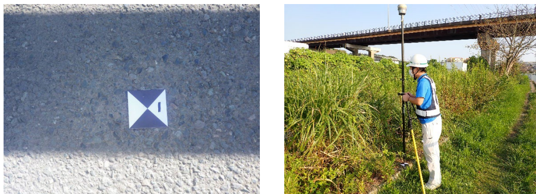
図4 標定点測量実施状況(左図:設置した標定点,右図:測量状況)
