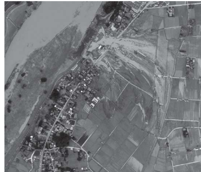
平成27年9月 鬼怒川決壊の際に形成された破堤堆積地形 (クレバスプレー)
