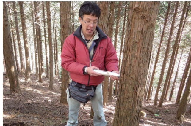
▲ピロディンによる陥入試験
