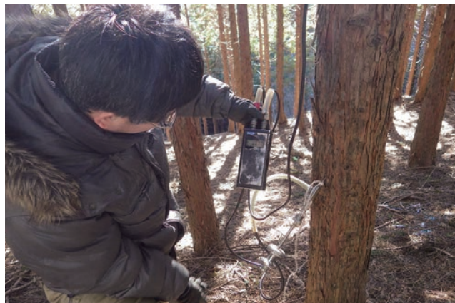
▲ファコップによる応力波伝搬速度 (森林総合研究所林木育種センター 協力)
