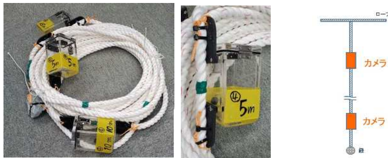
図2 設定水深毎にロープに取り付けたカメラのハウジング（左）と吊下げ時の模式図（右）
