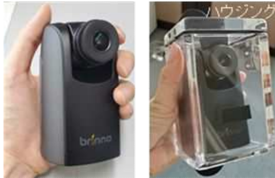
図1 定置網内の水中映像撮影に使用したタイムラプスカメラ
