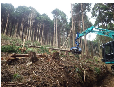
高性能林業機械(ハーベスタ)を利用した伐木作業の様子
