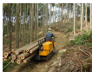
フォワーダによる運材作業の様子
