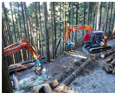
高性能林業機械(スイングヤーダとグラップル)を利用した集材作業の様子
