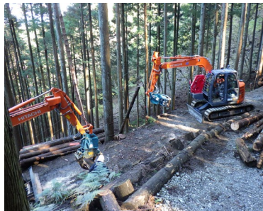
高性能林業機械(スイングヤーダーとグラップル)を利用した集材作業の様子
