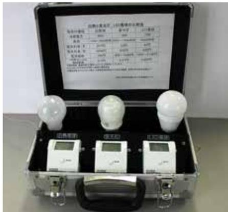
LED・電球エネルギー比較実験器
