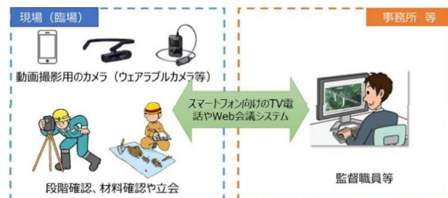
【建設工事における遠隔臨場】
