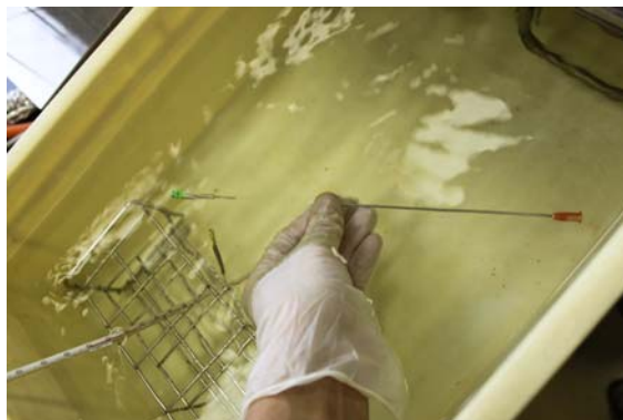
図10 ストロー内一段階希釈法の希釈液への導入の様子
