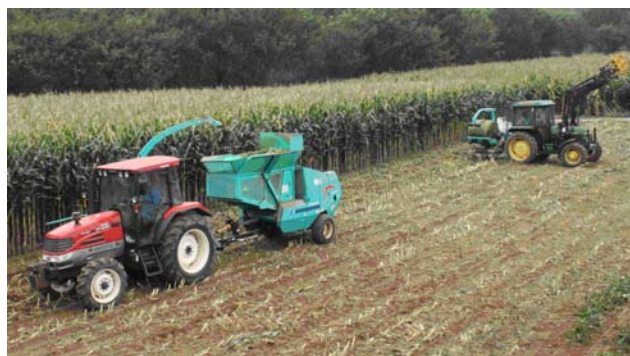
図1 細断型ロールベアラによる収穫作業
