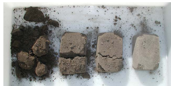
写真2 土壌と土壌硬化材の混合試験 土壌硬化材の混合割合；左から 7.0%、10.0%、15.2%、30.1%
