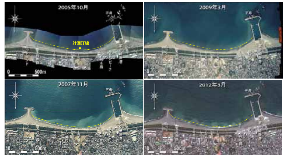
図-6 空中写真による海岸の経年変化（2005年10月～2012年3月）
