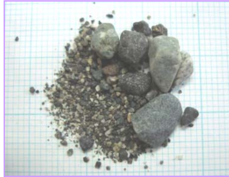
図-7 国府津地区の前浜の砂礫と前面の海底谷(水深200m)で確認された砂礫
