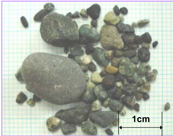
図-7 国府津地区の前浜の砂礫と前面の海底谷(水深200m)で確認された砂礫
