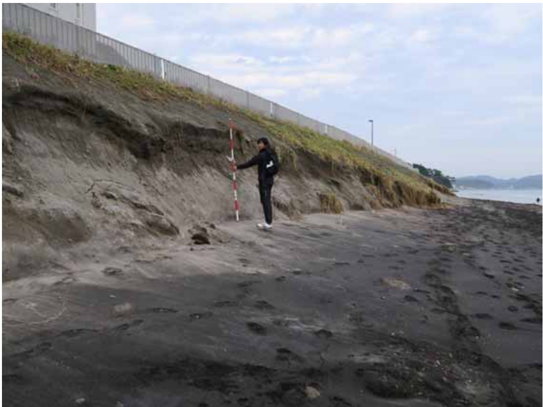
写真-6 地点6での比高約2 mの浜崖
