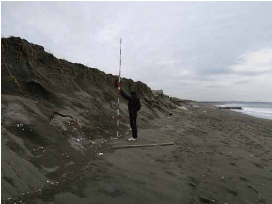
写真-13 4号水路の東380 mの地点13に形成されていた比高2.2 mの浜崖
