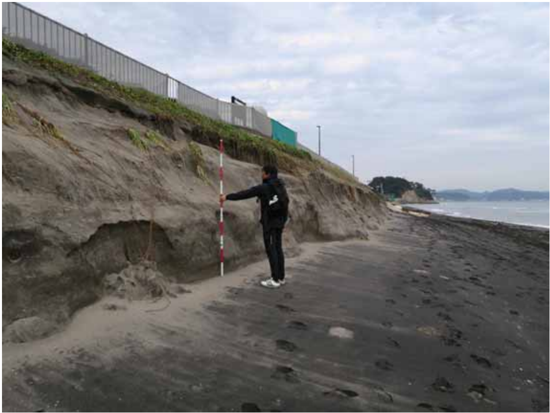
写真-7 地点7で再び3 mまで比高の増した浜崖
